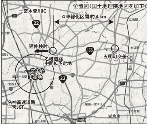
4車線化の対象区間は、江南市内の五明町交差点から一宮市内の名岐道路中間インターチェンジ(IC)仮称予定地に至る延長約4キロ。現在は暫定2車線で整備されており、4車線に拡張する。中間IC(国道22号)以西は、高架構造で整備する。計
